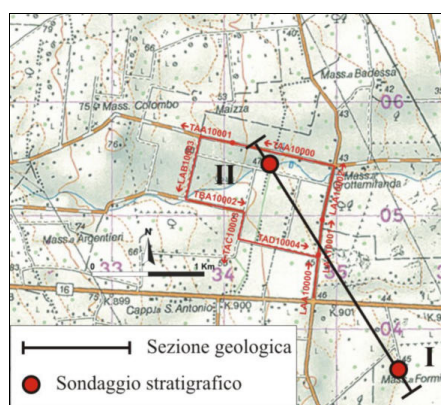
Figura 5: Area d'indagine presso S.Vito dei Normanni (Br): ubicazione delle linee di scansione (la direzione delle frecce indica il verso di avanzamento del Georadar).
