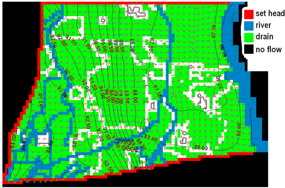
Figura 14: Condizioni al contorno assegnate al modello. Figure 14: Boundary conditions assigned to the model
