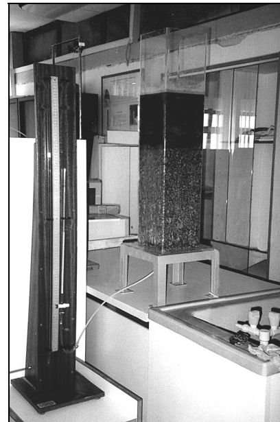
Figura 4. Immagine dell'apparecchiatura sperimentale View of the laboratory column infiltration test apparatus
