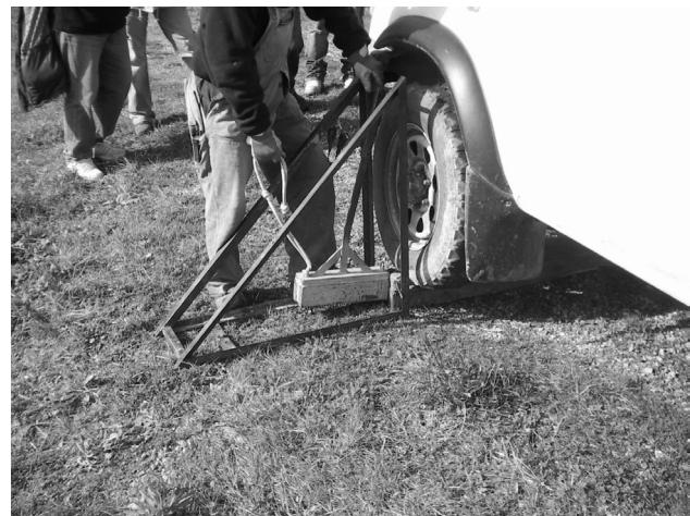
Fig. 4 Energizzazione trasversale con pendolo ad impatto orizzontale (Onde S) Transversal powered (S waves)
