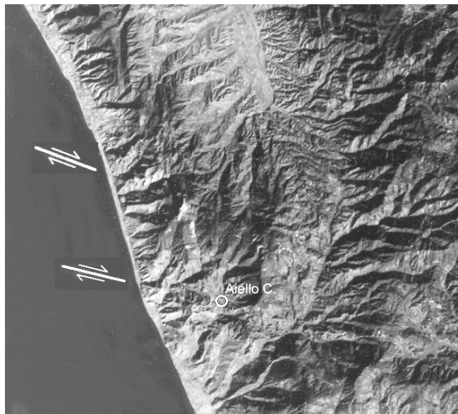
Fig. 2 – Immagine Landsat della Catena Costiera meridionale da cui si evince la trascorrente destra WNW-ESE che attraversa il territorio di Aiello Calabro profondamente devastandolo
