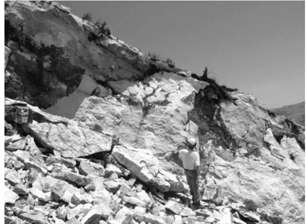
Fig. 9: In questa foto si nota la variazione nell'orientazione della scarpata di frana coincidente con un giunto N20 - 80^\circ in corrispondenza di una ponte di roccia che ne interrompeva la continuità
