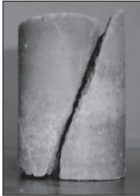
Figura 5. Provino di terreno stabilizzato con calce al termine della prova di compressione triassiale.
