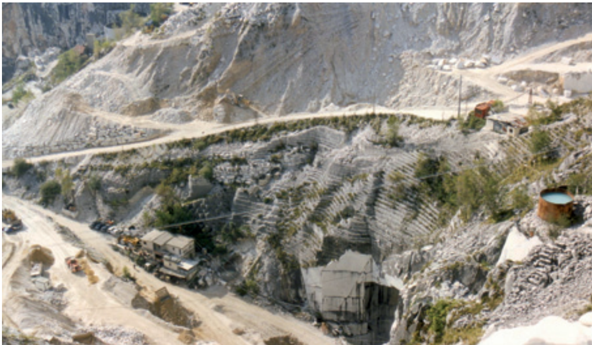
Figura 2: Opere di sistemazione delle piste di accesso alle cave, sfruttando le scaglie presenti nei ravaneti. Figure 2: Using the quarry wastes it is possible to realise service tracks for the exploited area.
