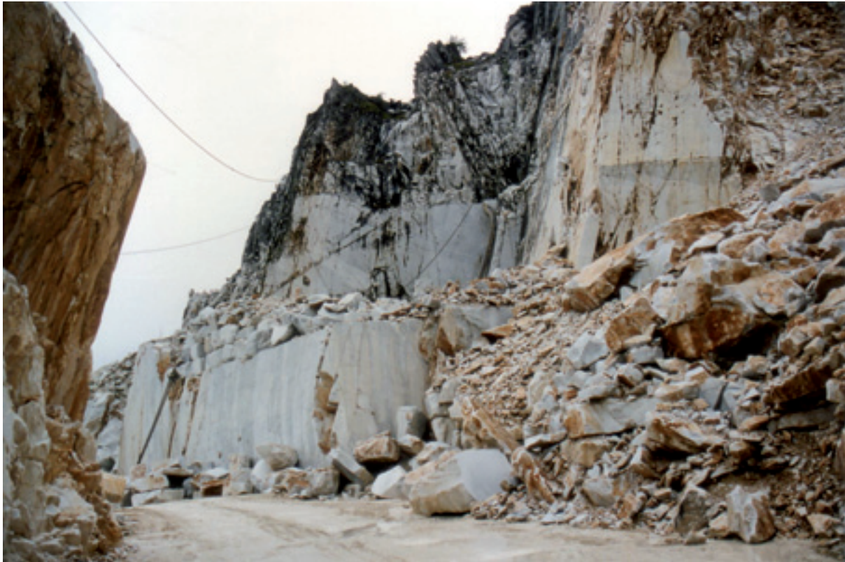
Figura 1: Depositi temporanei di scaglie presso una cava presente nel comprensorio apuano. Figure 1: Temporary quarry dumps in the Carrara marble basin.
