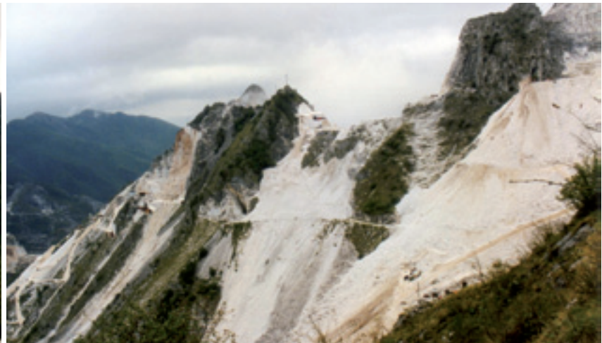
Figura 8: Pittoreschi ravaneti nel bacino marmifero apuano sui quali sono ricavate le piste di accesso in cava. Figure 8: Carrara marble quarry dumps: the tracks to the quarry pits are built on the dumped material.
