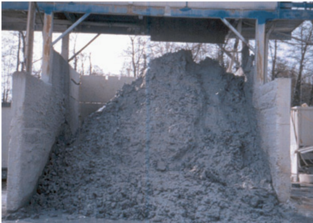
Figura 11: Cumulo di fanghi filtro pressati. Figure 11: Filter-pressed sludge stock pile.
